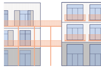
Fassade mit Laubengang
